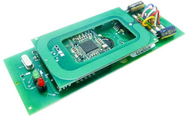
Das RFID Einbaumodul Mini LEGIC wurde zur universellen und einfachen Integration in vorhandene Gehäuse entwickelt.
