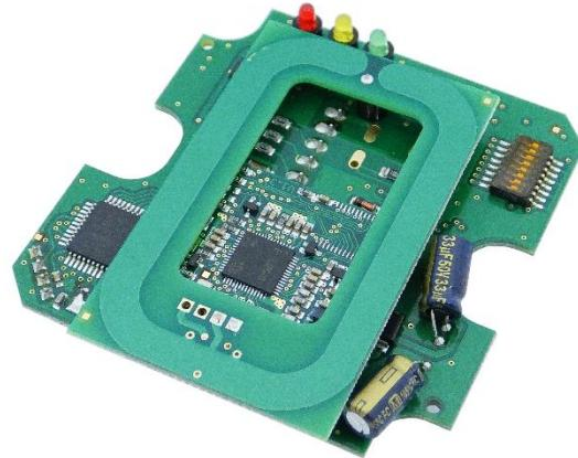
Das RFID Einbaumodul MCR (Multi Card Reader) LEGIC wurde zur universellen und einfachen Integration in vorhandene Gehäuse entwickelt.
