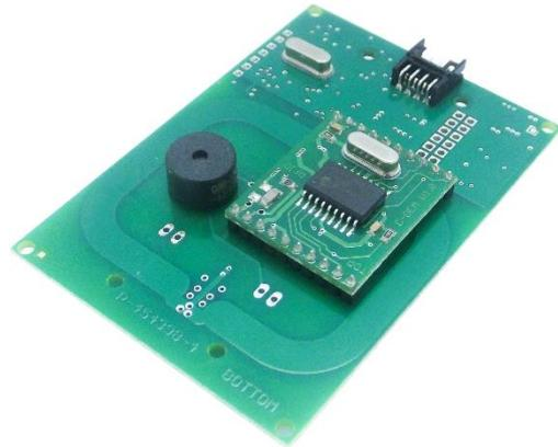
Das Einbaumodul Multiplex EM ist ein modernes und benutzerfreundliches RFID-Lesegerät für die einfache Integration in unterschiedliche Anwendungen.
